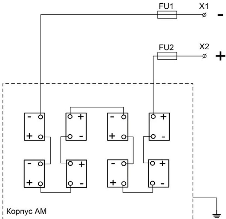
FU1,FU2 - Держатель предохранителя RT-18
